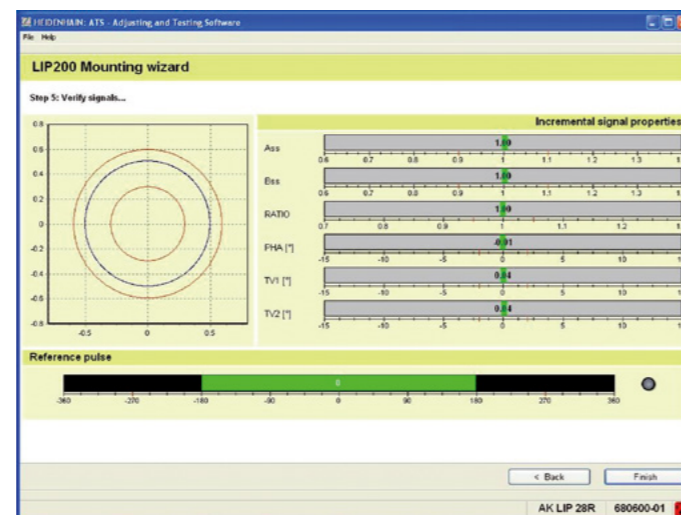
PWM 21/ATSソフトウェアを用いた取付け調整
