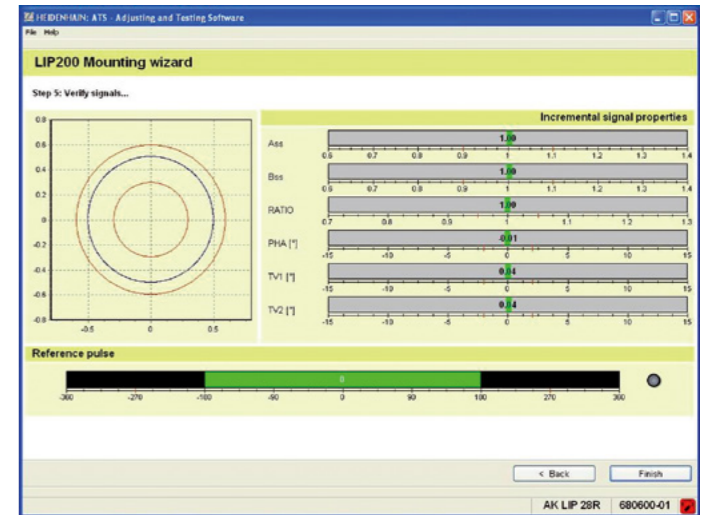
PWM 21/ATSソフトウェアを用いた取付け調整
