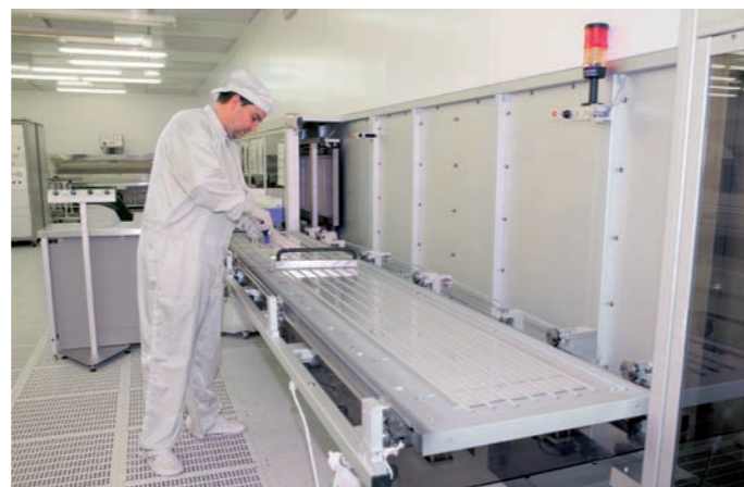
Impianto sotto vuoto per l'applicazione di strati di cromo
